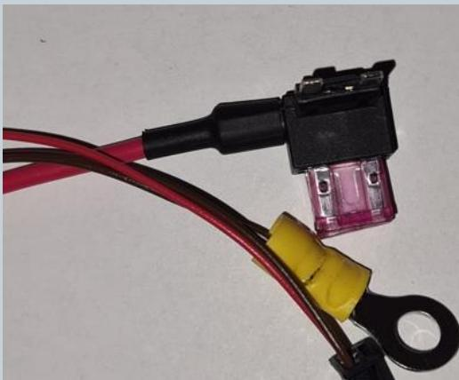
1. Schließen sie zuerst die Masse an. Hierfür wird eine 10er Nuss benötigt. Der Massepunkt ist gleich neben dem Sicherungskasten im Fußraum hinter dem Teppich zu finden.
